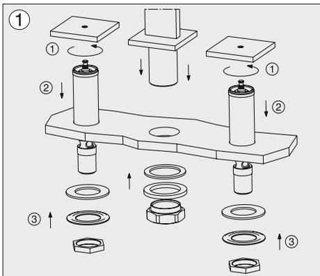
Colocar las llaves de paso y caño por encima del sanitario, y colocar las fijaciones por debajo.
