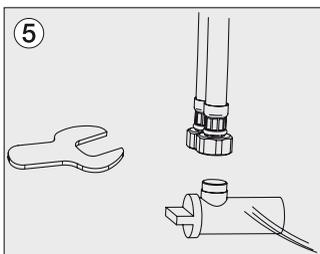
Conectar las manetas a las conexiones de agua.
