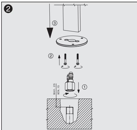
Conectar la boca directamente a la tubería y fijarla con las fijaciones.
