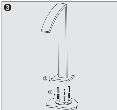
Hacer la conexión entre las llaves de paso y la boca (conexiones no incluidas).
