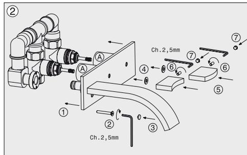
Preparar el hueco de la pared para el cuerpo interno según la cota A, B y C del explosionado. Colocar el cuerpo con su protección (si la lleva) dentro del agujero. Conectar los tubos de alimentación (caliente a la izquierda y fría a la derecha).
