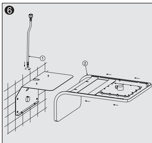
Atornillar el flexible (1) e insertar el cuerpo externo (2) sobre la trasera.
