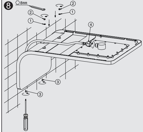
Bloquear a través de las arandelas (1), los pernos (2) y las roscas (3). Atornillar por tanto el flexible (4) al raccor (5).
