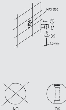
Atornillar el rafcor (1) al tubo de 1/2" predisposto en el muro y atornillar el tapón (2).
