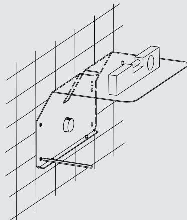
Apoyar la trasera a la pared y señalar la posición de los tacos para la siguiente fijación de la trasera.
