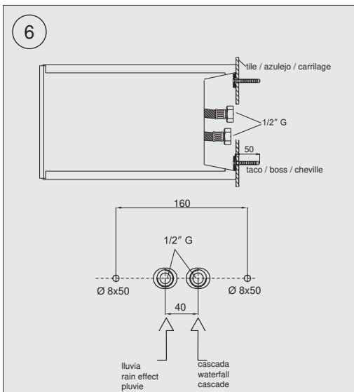
6. Conectar los flexibles de  $\frac{1}{2}$ " a las tuberías, teniendo en cuenta la salida para la función lluvia y la salida para la función cascada. Colocar de nuevo el nivel para asegurarse que el producto está bien instalado y finalmente atornillar el rociador a la pared. La tornillería incluida en la caja NO es compatible con la pared de pladur.
