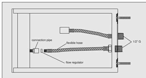
8. Para cambiar o limpiar el limitador de caudal, quitar la tapa superior del rociador. Posteriormente, desenroscar el flexible más largo. Utilizar pinzas para sacar el limitador de caudal para limpiarlo con agua o cambiarlo en caso de estar dañado. Volver a montar el rociador siguiendo las instrucciones de montaje.
