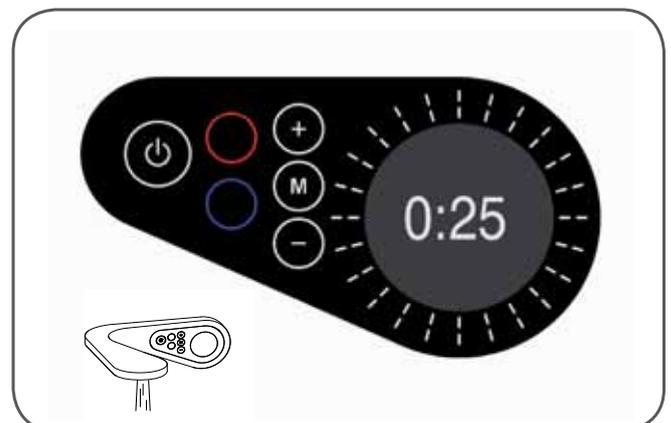
Seguidamente me aparecerá el tiempo en pantalla, y le indicará la duración del programa que estoy modificando. El tiempo desde los 5 seg.a 1:30 seg.se incrementará a intervalos de 5 segundos. A partir de 1:30 seg.se incrementará a intervalos de 30 seg.hasta llegar a un máximo de 5 minutos.
