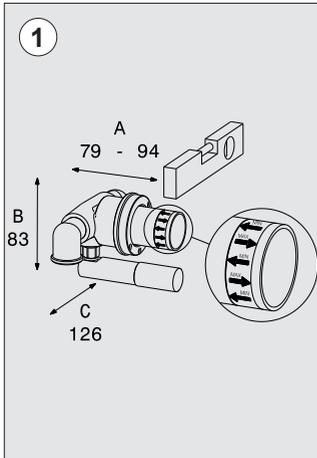
Instalen el mezclador como indicado en la figura; antes de colocar las baldosas, pongan el sistema en seguridad, cerrando el agua.
