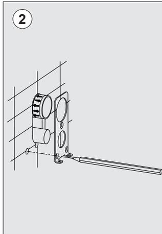
Apoyar la placa a la pared y marcar la posición de los agujeros para la sucesiva fijación del cuerpo del grifo.
