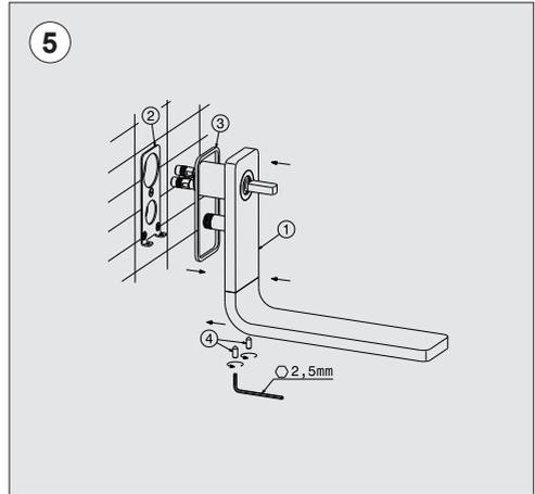
Sobrepongan el cuerpo del grifo (1) a la plancha (2) interponiendo la esponja (3); atornillen las clavijas de fijación (4) para asegurar el grifo.
