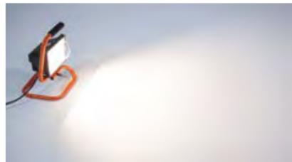
4- La iluminación del lugar de trabajo ha de ser lo suficientemente intensa como para detectar con facilidad cualquier defecto de colocación, especialmente "cejas" entre baldosas. Se recomienda trabajar con focos eléctricos y una iluminación superior a la de uso.
